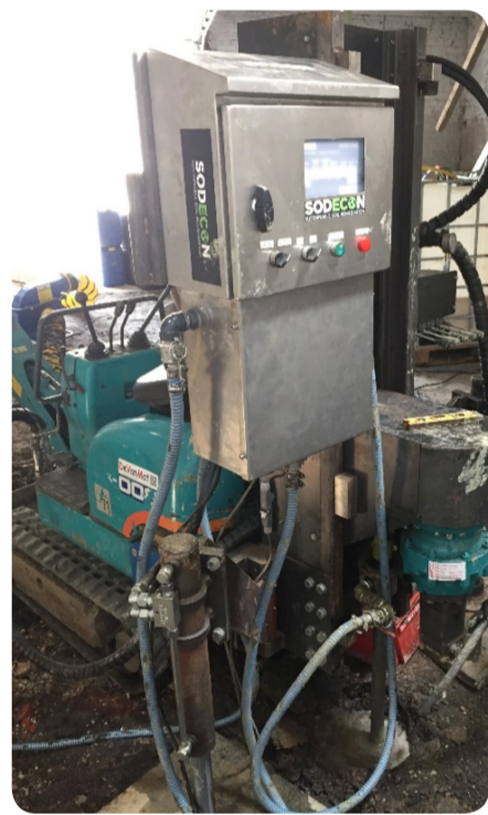
Foto: injectie met Micro Spin op een voormalige droogkuislocatie
